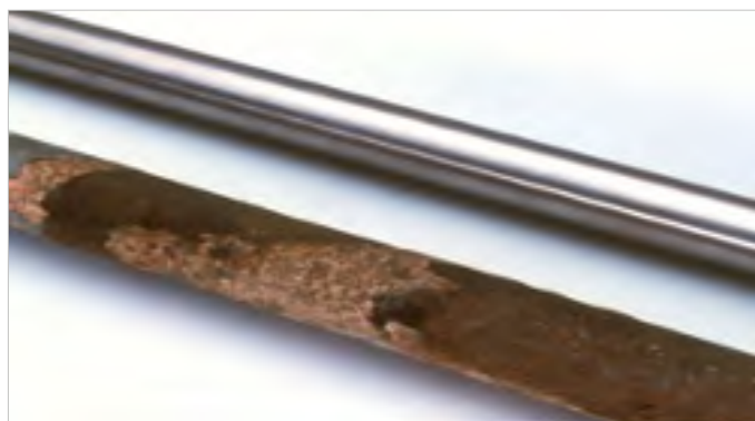
Ruostumaton teräs vs. kuumasinkitty viiden vuoden jälkeen
