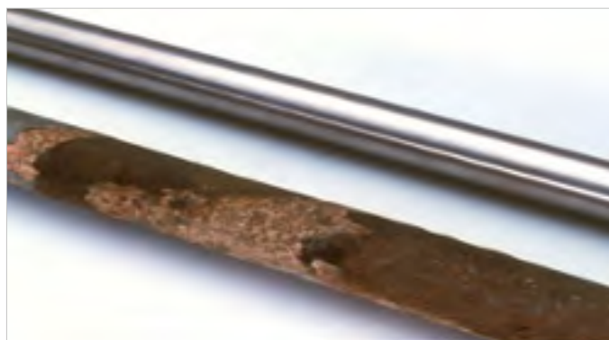
Ruostumaton teräs vs. kuumasinkitty viiden vuoden jälkeen
